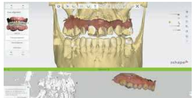
3. Étape de fusion des images issues de l'empreinte optique et de l'imagerie 3D.
